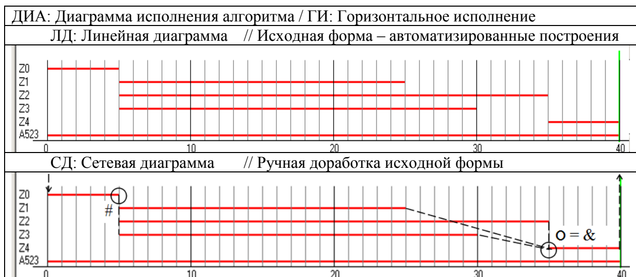
Рис. 4. Временная диаграмма дискретного процесса исполнения алгоритма
