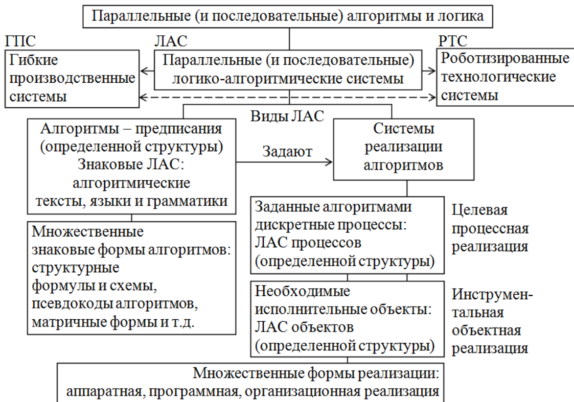
Рис. 1. Виды и формы логико-алгоритмических систем (ЛАС)
